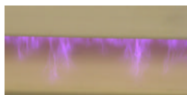
„Entladungsgewitter“ zwischen den Elektroden
